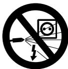
Электрические приспособления, соединения и токопроводящие провода не обрызгивать высоконапорной струёй либо с использованием шланга для воды – **опасность короткого замыкания!**
